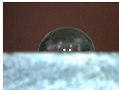
Figura 2: Ampio angolo di contatto con goccia d'acqua su superficie in marmo con trattamento SIOX-5 S (cod. SN1).
